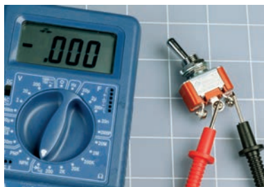
Rysunek 2.33. Kiedy przełącznik łączy dwie ze swoich końcówek, miernik pokazuje zerową rezystancję między nimi i wydaje dźwięk, jeśli ustawiłeś go na test przewodzenia
