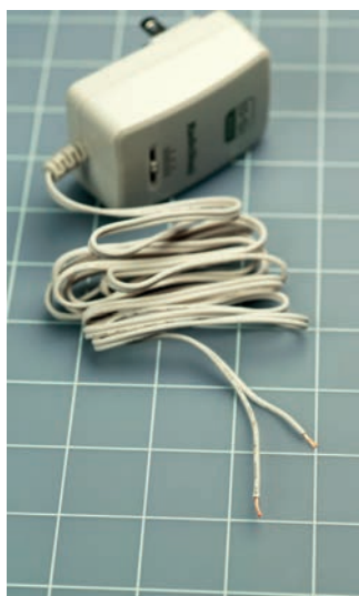
Rysunek 2.50. Po drugie, odizoluj przewody w taki sposób, aby jeden z nich był krótszy od drugiego. Zmniejszysz w ten sposób ryzyko ich wzajemnego zetknięcia. Pokoloruj przewód z wyższym potencjałem, używając markera, lub doklej do niego etykietkę
